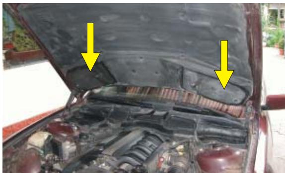
**(PL)** Podnieść maskę przednią, filtry przeciwpyłkowe znajdują się w symetrycznie rozmieszczonych prostokątnych obudowach
